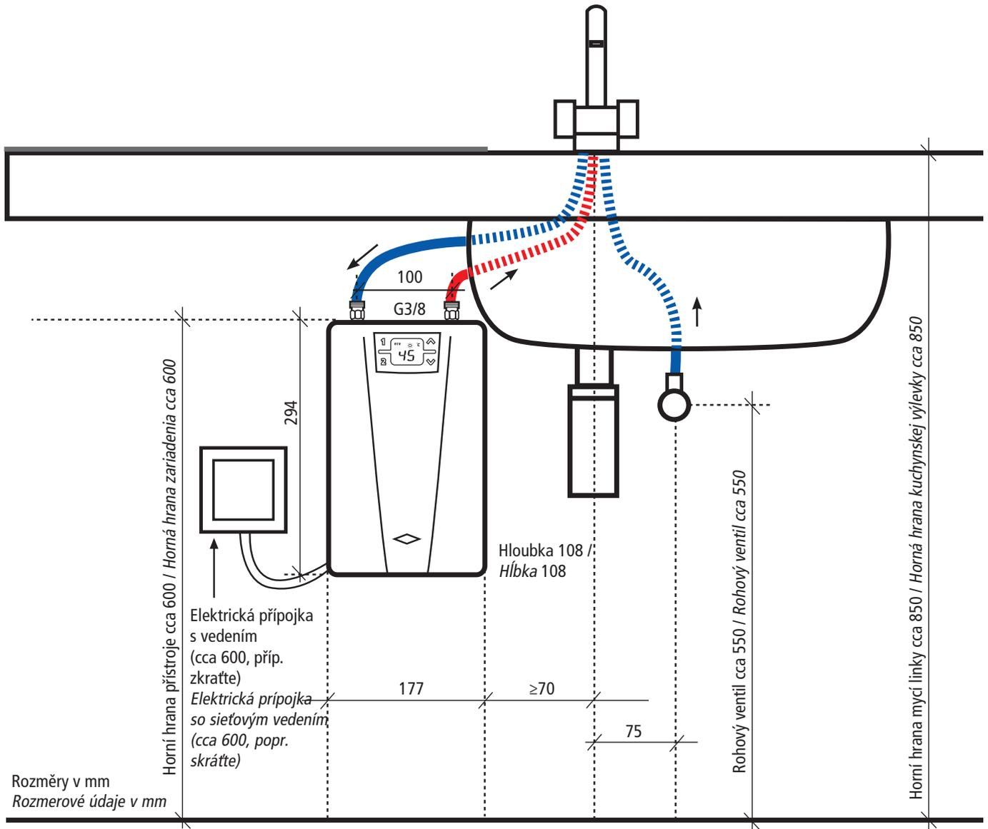
Instalace s tlakovou armaturou: / Inštalácia s tlakovou armatúrou:
