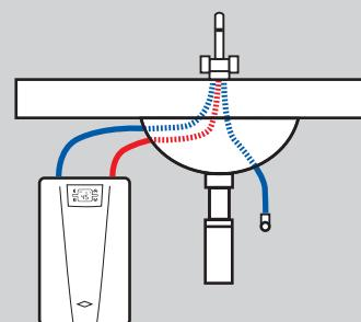
Instalace s propojovacím relé LAB (pokud není k dispozici přímé zapojení).
