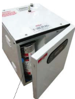
umístění filtru ve varné jednotce
